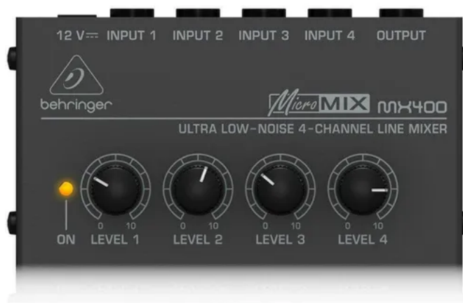
Figura 2 – Mixer Behringer Micromix Mx400, possui 4 entradas e 1 saída
